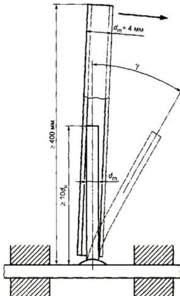
$d_m$  - максимальный размер поперечного сечения испытуемого арматурного проката
