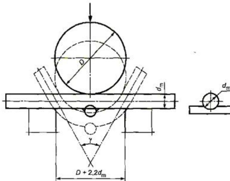
$d_m$  - максимальный размер поперечного сечения испытываемого арматурного проката
