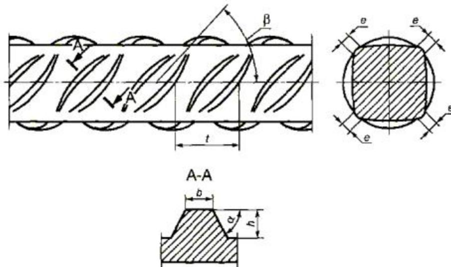
Рисунок А.3 - Четырехсторонний сегментный периодический профиль
